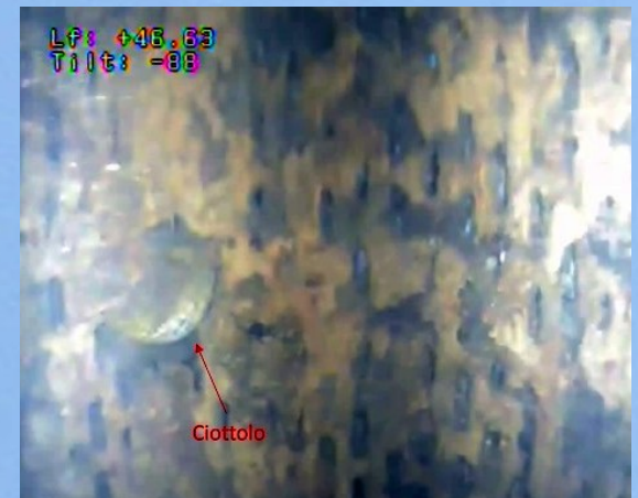
Ammaloramento del filtro
